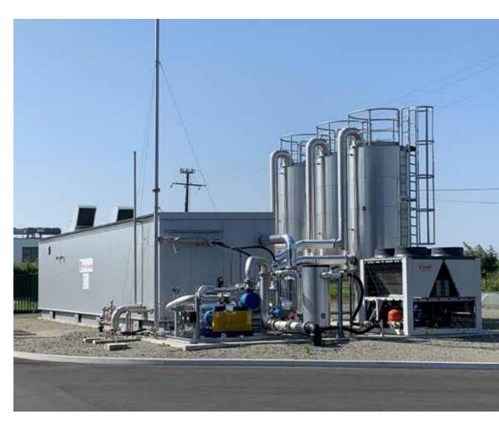
ir Liquide étend sa gamme de solutions d'épuration de biogaz avec sa nouvelle génération d'épurateurs développés pour les projets allant jusqu'à 1 000 Nm³/h, fruit de son retour d'expérience de plus de 15 ans.
